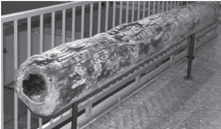
Bild eines Teuchels. Das Wasser wurde durch ausgehöhlte Baumstämme geführt. Die Teuchel legte man vor dem Einbau in die Erde zum Verlechnen in einen Weiher. Dabei saugt das trockene Holz Wasser auf.
